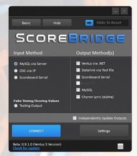
THE DATASTREAM FROM SCOREOCR™ IS TRANSCODED THROUGH THE INCLUDED SCOREBRIDGE™ APPLICATION, AND DELIVERED TO THE RENDERER OR DISTRIBUTION PLATFORM OF YOUR CHOICE.
